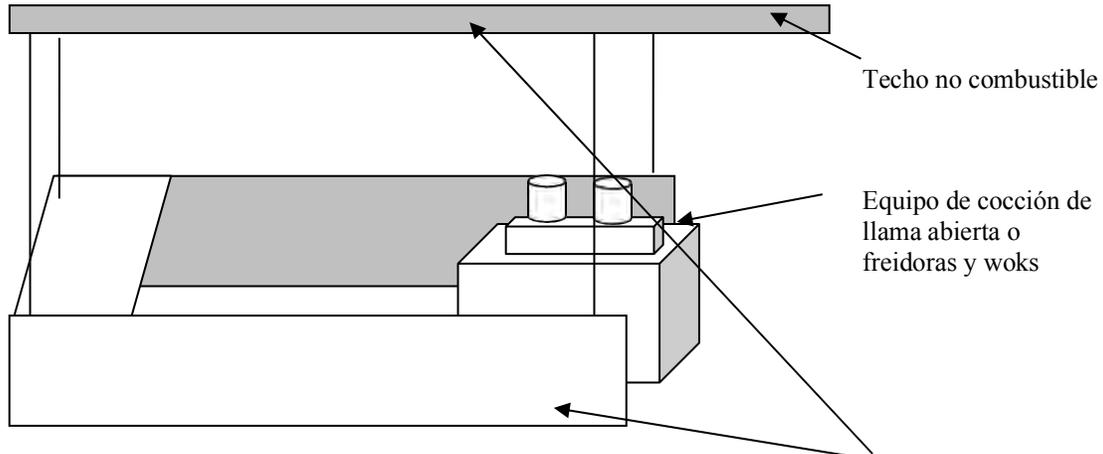
Si el revestimiento y la parte superior del stand están hechos de materiales no combustibles, es decir, metal, tablero de cemento, placa de yeso, etc., entonces
