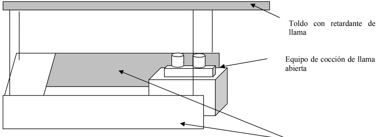
Material incombustible para el revestimiento del stand que se extiende 6 pulgadas por encima de las llamas abiertas.
