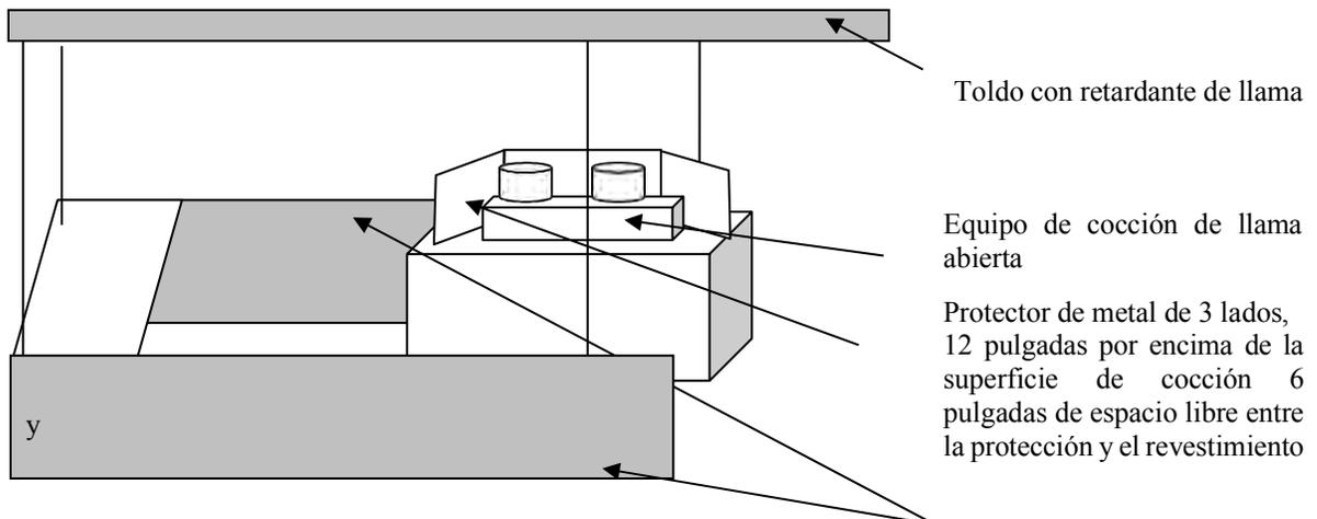
Material incombustible para el revestimiento del stand que se extiende 6 pulgadas por encima de las llamas abiertas.
